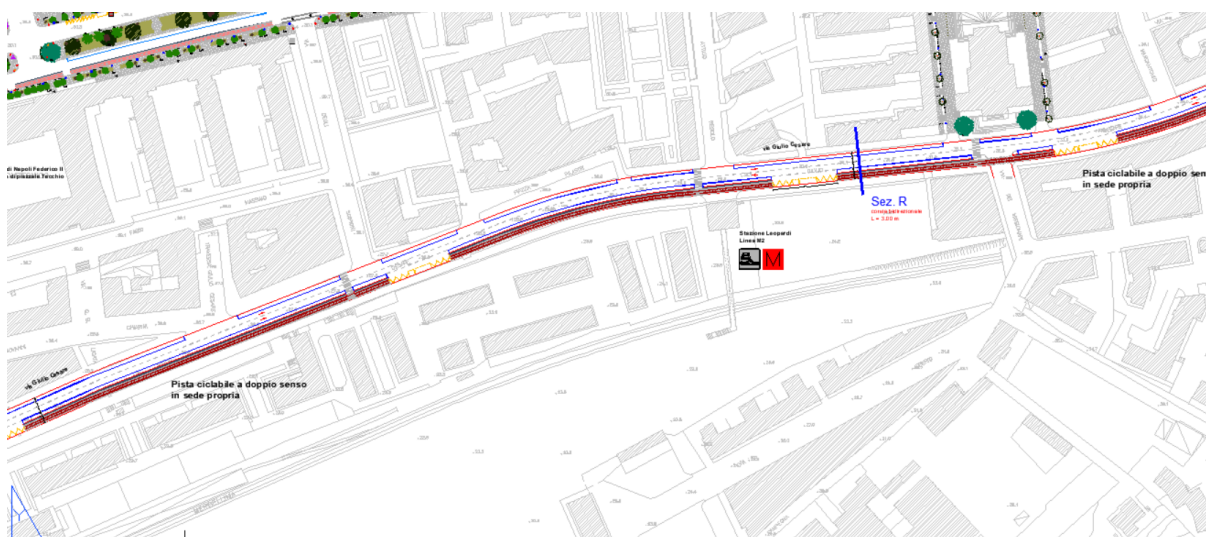
Figura 15.4: via Giulio Cesare, tratto centrale – andamento planimetrico.
